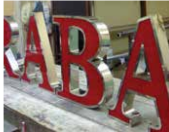
Chữ nổi inox mặt mica sáng đèn led
