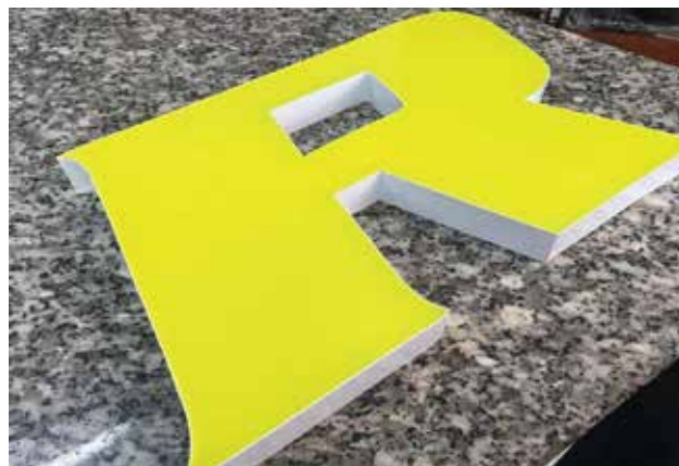
Chữ nhôm hàn quốc không viền, sáng đèn, mặt polycarbonate dán decal màu 3M
