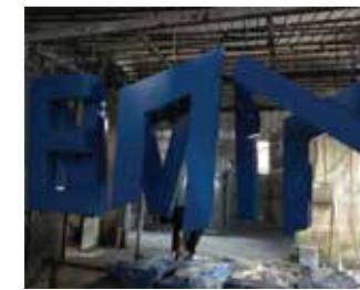
Chữ tôn tấm lớn sơn tĩnh điện
